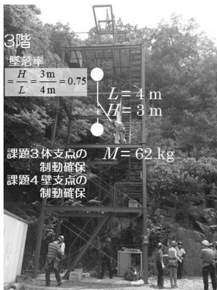
図3. 課題3と4の墜落条件。確保支点は3階壁面。8.5 mm ダブルロープ。ゼロピンを用いた。
